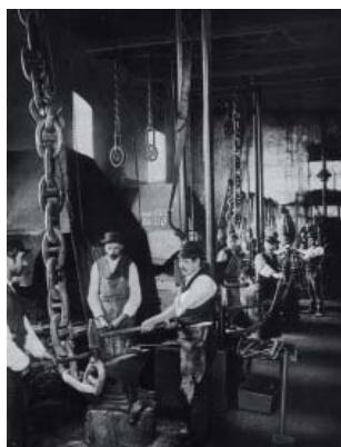
Kovárna pro výrobu kotevních řetězů 1878
