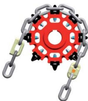
V případě protažení řetězů v důsledku opotřebení je pro získání přesné požadované délky nezbytné zkrácení řetězů. V případě nutnosti zkrácení řetězů, musí být vyříznut sudý počet řetězových článků (2, 4, 6, atd.). Stejný počet článků musí být oddělen z obou řetězových smyček.
