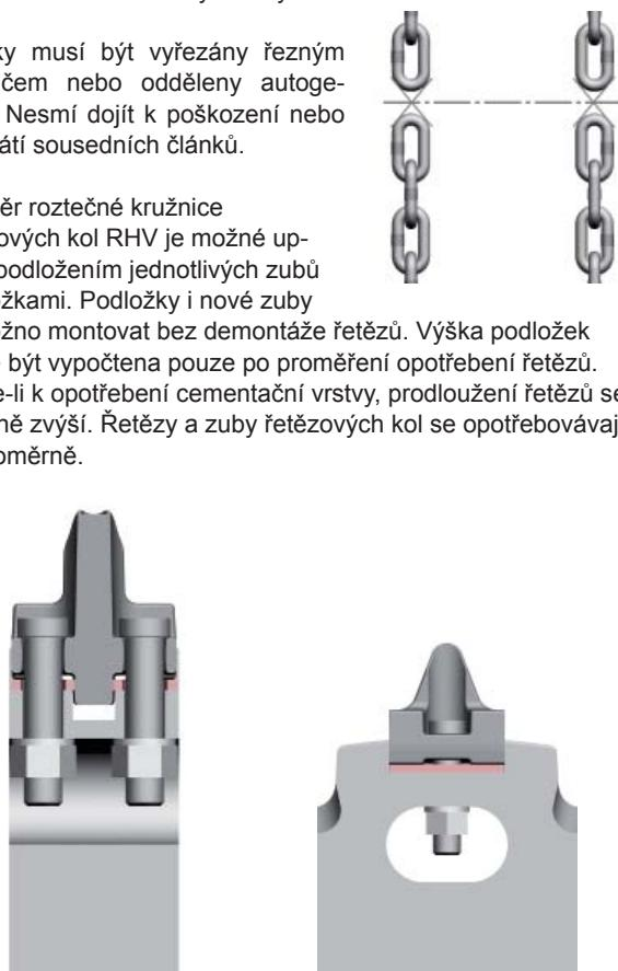
Podložky by měly být namontovány v případě prodloužení řetězů v důsledku opotřebení přibližně o 2,5%. Doporučená výměna řetězů je u třídy kvality E10 při prodloužení přibližně o 3,5% a u třídy kvality E14 při prodloužení přibližně o 5%.
