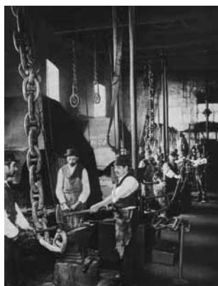
Kovárna pro výrobu kotevních řetězů 1878
