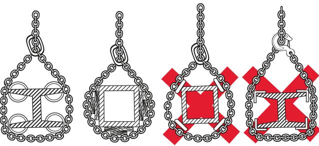
Jsou-li řetězy vedeny přes hrany bez potřebné ochrany, snižuje se významně jejich nosnost a nelze garantovat bezpečné použití. Odpovídající faktory zatížení viz tabulka na str. 20. Pokud je řetěz třeba omotat kolem nosníků nebo jiných kulatých nákladů, měl by být použit řetěz o průměru alespoň 2-3krát větším než je rozteč řetězu. Při použití menšího průměru musí být nosnost snížena o 50 %.
