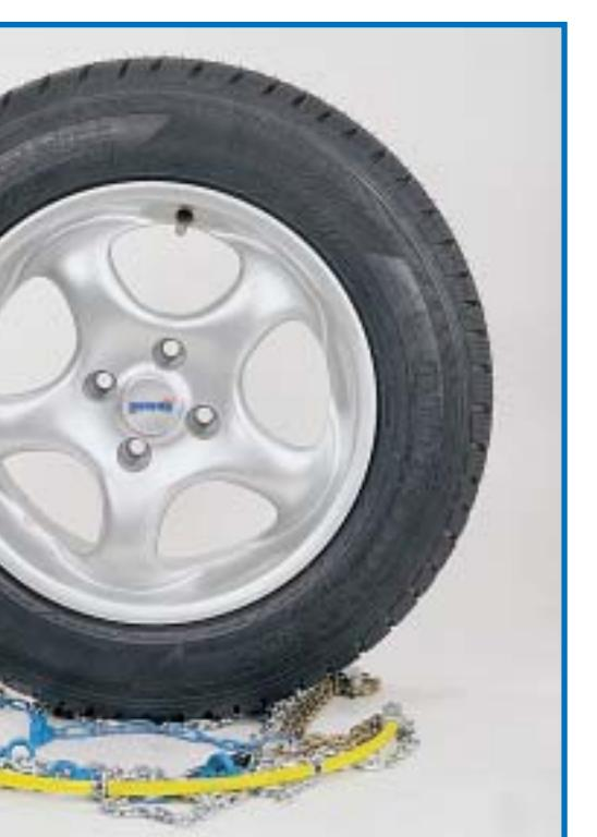
D Am leichtesten ist die Kette zu demontieren, wenn sich die Kette in der am Bild abgebildeten Stellung befindet (Verschlussplatteposition beachten).
